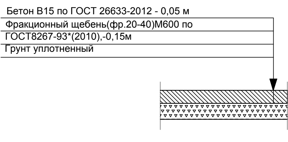
Конструкция покрытия площадки ТБО (Тип X)
