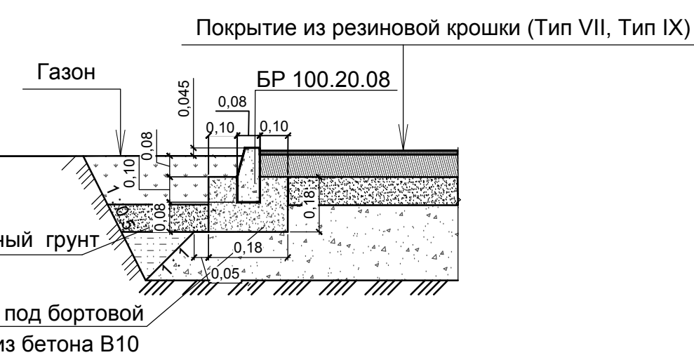
Устройство бортового камня БР 100.30.18
